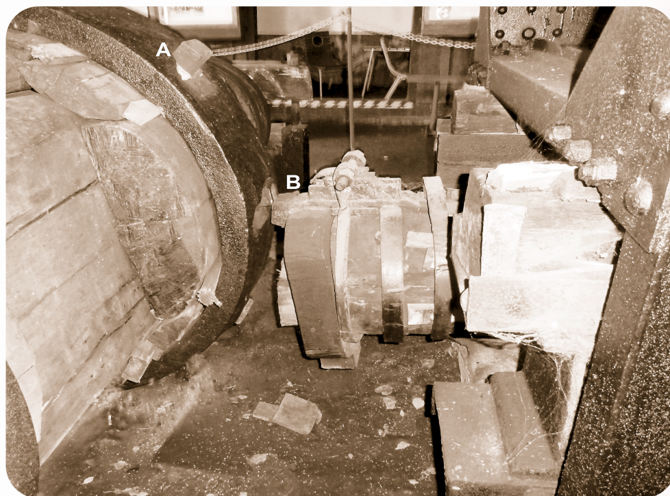
Przy obrocie wału koła wodnego występ A naciska na koniec B dźwigni...
